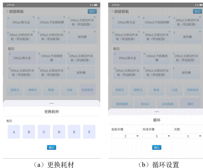
图 7 更换耗材设置 (a) 与循环步骤设置 (b)
