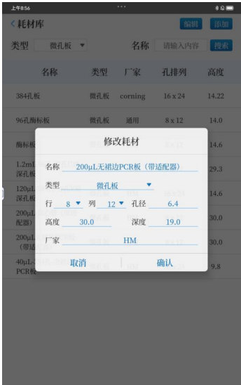
图 3 耗材修改参数（以 200 \mu L 无裙边 PCR 板（带适配器）为例）
