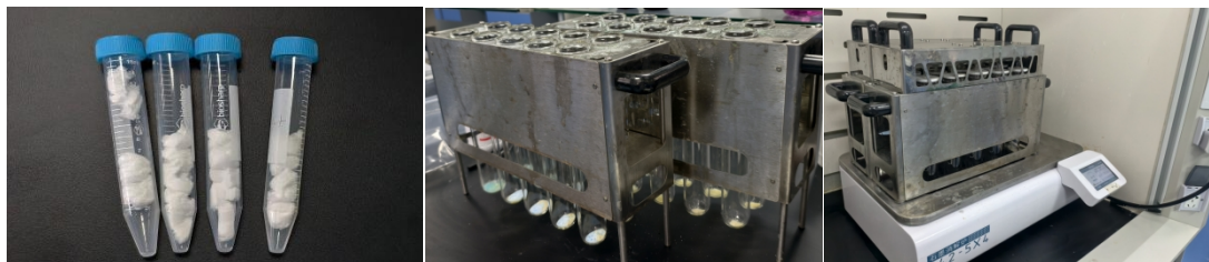
图 2 石墨消化炉消解过程图
