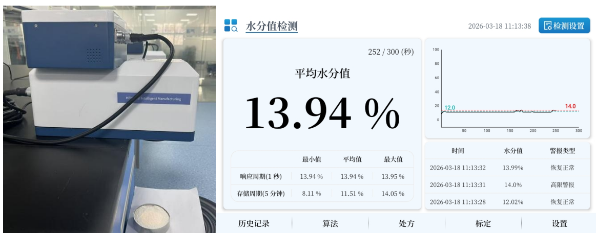
图 3：目标样品水分含量测试过程及界面图（实验室测试）
