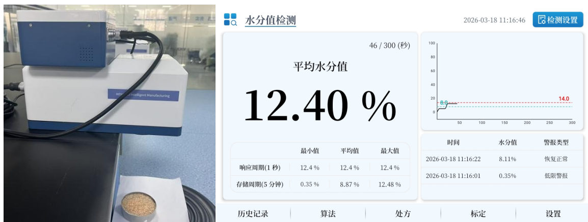
图 3：目标样品水分含量测试界面图
