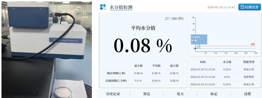
图 3：目标样品水分含量测试过程及界面图（实验室测试）
