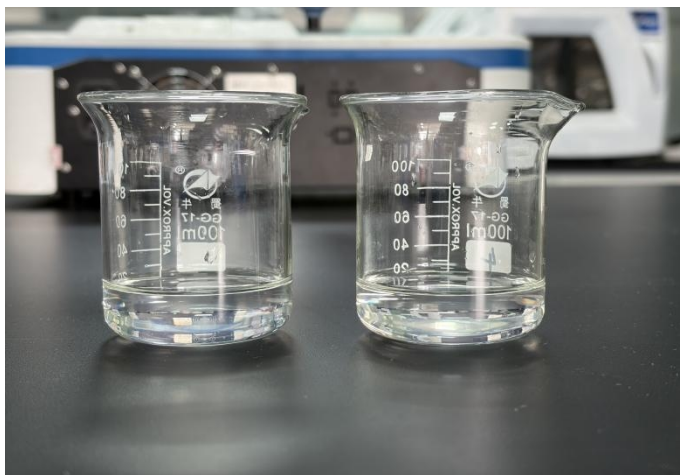
图3 氧化铝消解络合后状态（转移便于观察）
