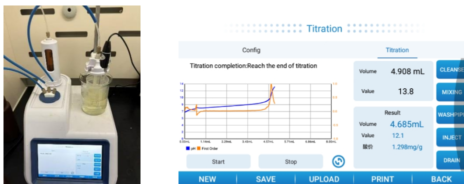
图 4：滴定过程及滴定曲线与一阶微分曲线示意图
